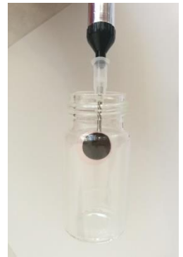
Plazieren eines selbstklebenden Sensorspots in einer Glasflasche
